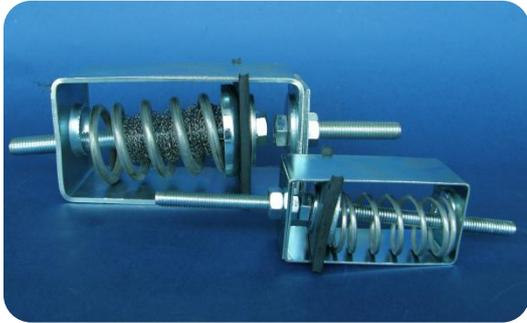
Los antivibratorios Silentflex® de tracción tipo B están constituidos por un resorte cilíndrico de acero inoxidable, un soporte en chapa galvanizada, una guía de aislamiento acústico en elastómero, y un eje o dos varillas roscadas, una varilla y un gancho o doble gancho, según el modelo.
